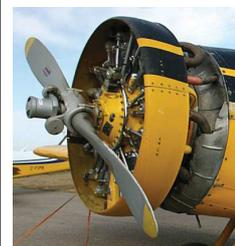
entre le neuf cylindres étoile de **600 CV** situés à plus de 4 mètres et le poste de pilotage se trouve une cuve de **1200 litres** destinée au produit à épandre, et en convoyage à nos valises. La mise en route, « clear prop », hélice drapeau, plein riche, premières injections pour amener l'essence des ailes aux primers, ensuite
